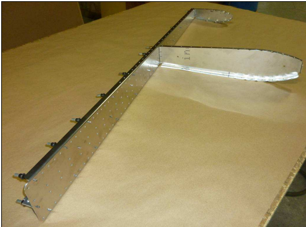
P/N: C75R2-7 Fin Nose Rib
