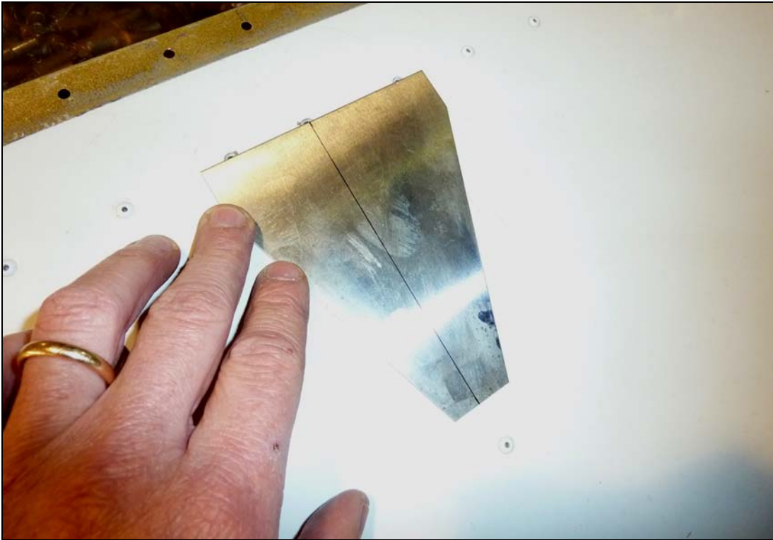
P/N: 65W2-5 Aileron Rib #2 Gusset
