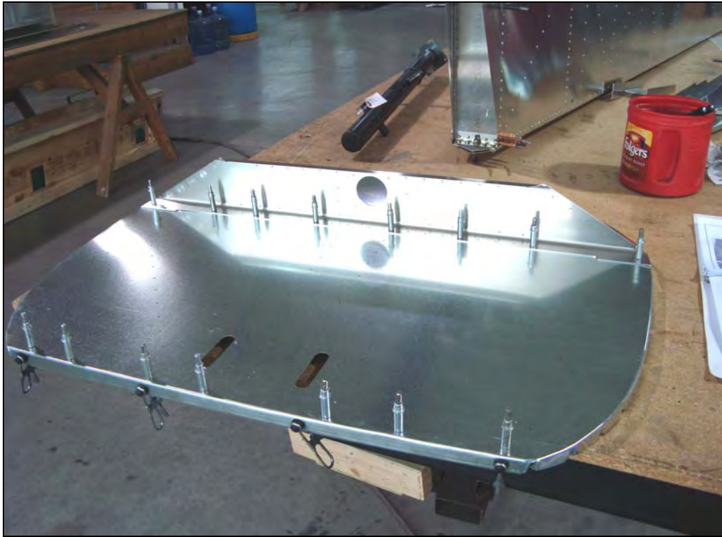
P/N: 6B7-1 Firewall Top Stiffener
